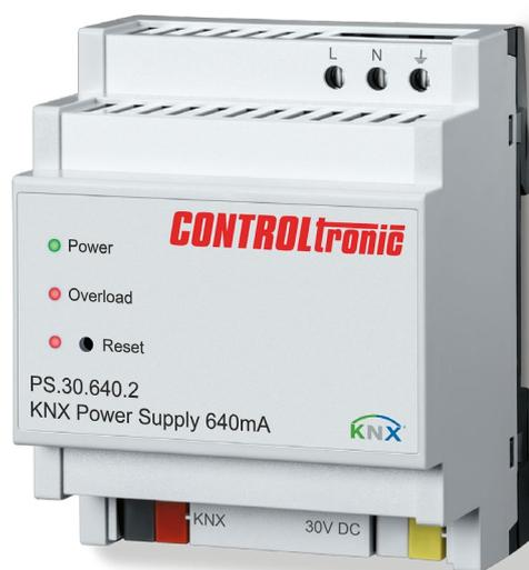
KNX Spannungsversorgung mit integrierter Drossel. LED-Anzeige für Betriebsbereitschaft, Überlast und Reset. Taster für automatischen Reset auf der KNX Linie. Zusätzlicher unverdrosselter Hilfsspannungsausgang mit 30V DC. Der Gesamtnennstrom an den kurzschlussfesten Ausgängen beträgt 640mA.
